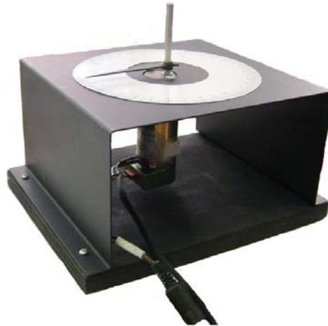
figura 1 – Motore con lancetta, riduttore ed encoder incrementale
